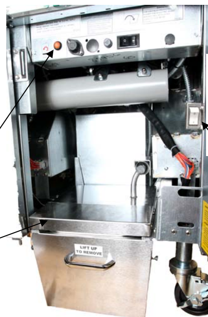
Figure 3 : Fixez les connecteurs blancs à deux broches et branchez le connecteur noir au coffret de prise de courant ainsi que montré.
